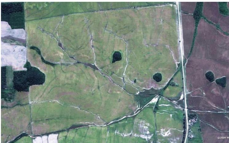
Del análisis de ésta caso en particular, se observa que el canal de desagüe principal de la localidad, desemboca en una mancha de monte para luego desaparecer como canal agua abajo de la misma.
